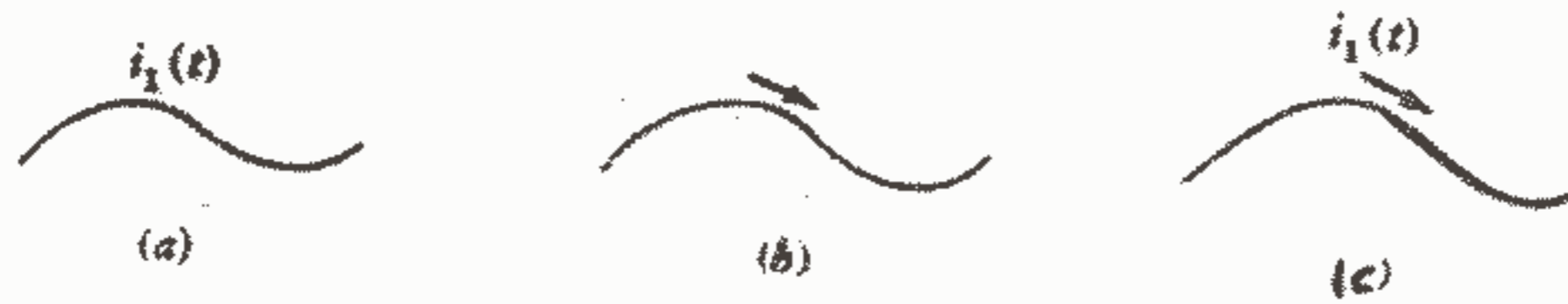
شکل ۶ - ۱: (a) و (b) تعاریف ناقص، نامناسب و غلط یک جریان می‌باشند. (c) تعریف صحیح i_1(t) .
