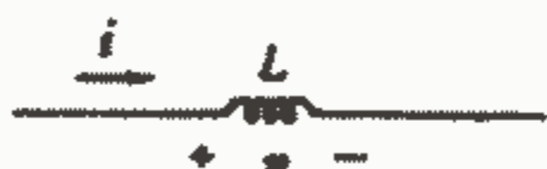
شکل ۱ - ۴: علامت مبنای ولتاژ و جریان در علامت مداری سلف
