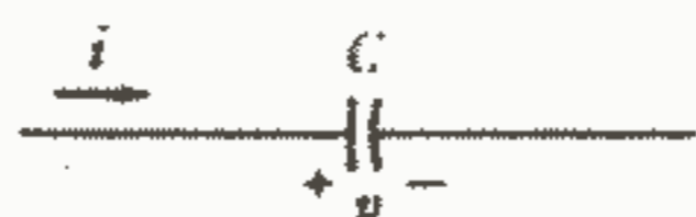
شکل ۷ - ۴: علائم مبنای ولتاژ و جریان بر روی علامت مداری
